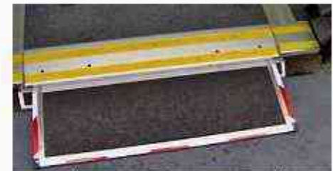
Rampe courte portes 2 et 3
